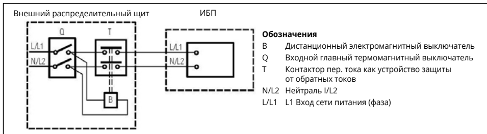
Проводка внешней системы защиты от обратного питания
